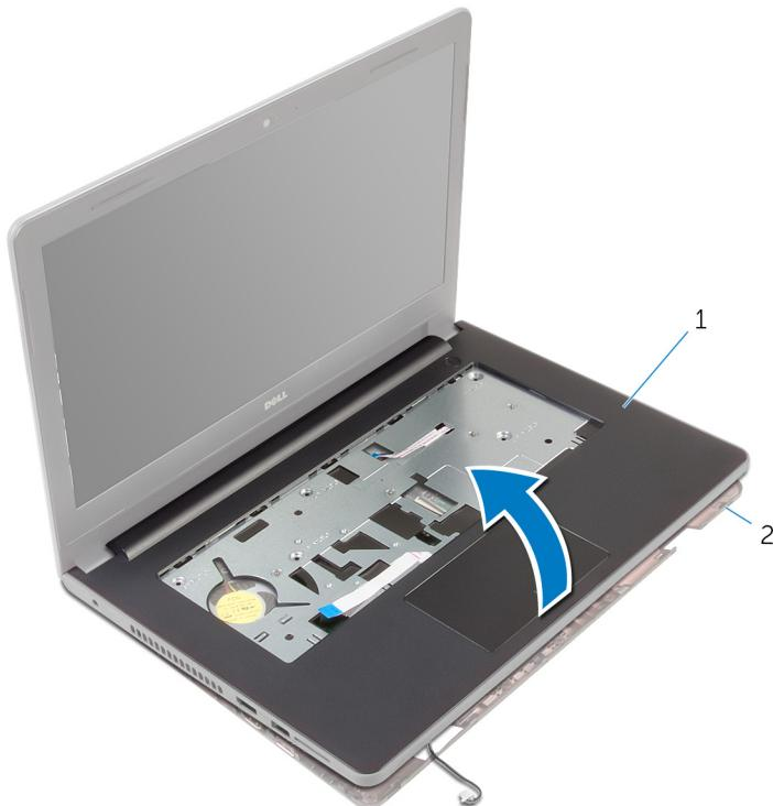
1 διάταξη στηρίγματος παλάμης      2 βάση υπολογιστή
